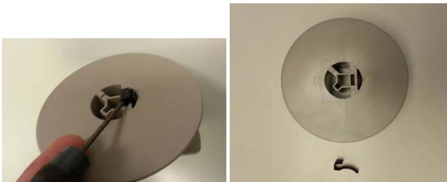
Drehen Sie die Ausgabespule um, um die Feder mit einem Schraubendreher ausbauen zu können. Setzen Sie die Ausgabespule zurück auf die Achse, drücken Sie sie fest zurück in ihre Position und ziehen Sie die Madenschrauben fest.
