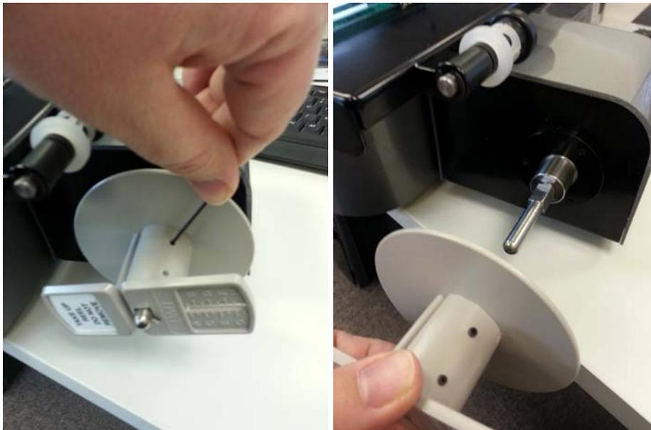
Es ist ein Inbusschlüssel erforderlich, um die zwei Ausgabespulen-Madenschrauben mit 1/16 Inch bzw. 0,162 mm zu lösen. Lösen Sie die beiden Schrauben und schieben Sie dann die Ausgabespule von der Achse.
